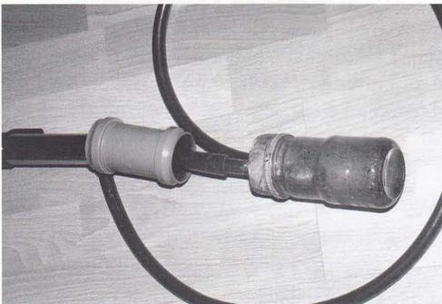
Abb. 1. Exhauster zum Ansaugen der Fliegen.
